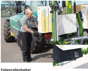
Zwei auf Wunsch vorne links und rechts an den Wickler montierbare Folienhalter ermöglichen das Mitführen von insgesamt vier Folienrollen. In diese Halterung integriert sind eine zusätzliche Beleuchtung sowie eine externe Bedienung. Über deren Taster lässt sich der Wickelarm etwa zum Folienwechsel in beide Richtungen verdrehen und die Schneidvorrichtung öffnen und schließen.
